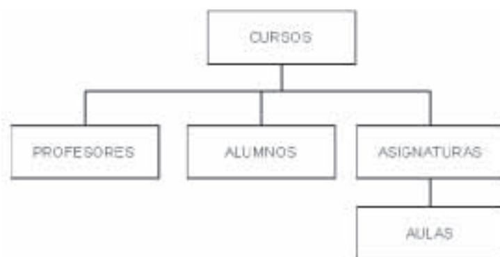
Figura 1.33. Esquema jerárquico de 5 segmentos y 3 niveles.
