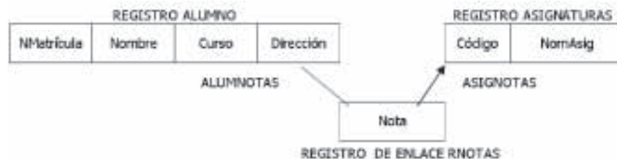
Figura 1.32. Ejemplo diagrama de estructuras. Relación 1:M.
