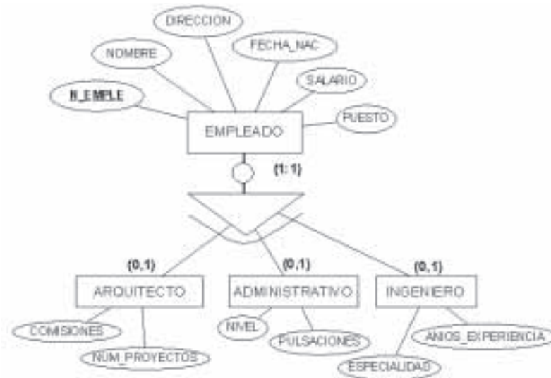
Figura 1.12. Representación de una generalización.
