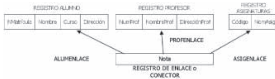
Figura 1.27. Diagrama de estructuras de la relación uno a uno con registro de enlace y atributos.
